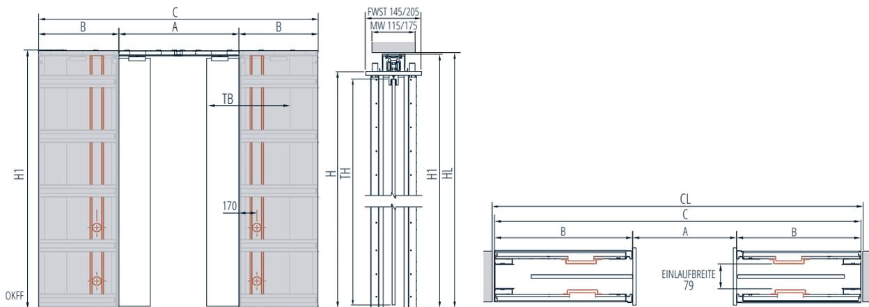
FWST = Fertigwandstärke | CW = Profilstärke | \* Doppelbeplankung | \* bei Kabelkanal vormontiert für FWST 145/205
